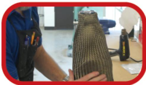
In genere utilizziamo due strati di basalto, con maglia di nylon di base in un ordine diverso a seconda della finitura e nastro di carbonio sull'estremità distale.
