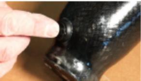
9. Posizionare con cura la base della valvola nel foro praticato. Tenere la base saldamente in posizione.
